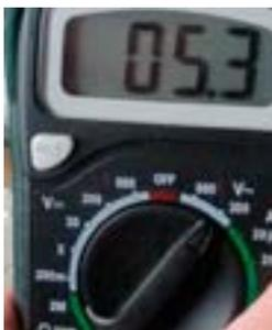
Pour cela, il faut au préalable régler le multimètre : la molette doit être positionnée sur la fonction voltmètre pour courant alternatif (symbole V~) et sur la mesure 200 V (comme le montre la photo). Si le multimètre le permet, un voltage plus petit (ex : 20 V) pourra donner une mesure plus précise.
