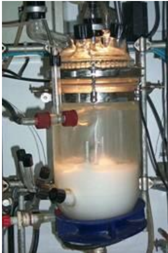
Réacteur de polymérisation basse pression (1 bar)
