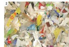
Paillettes après lavage et broyage
