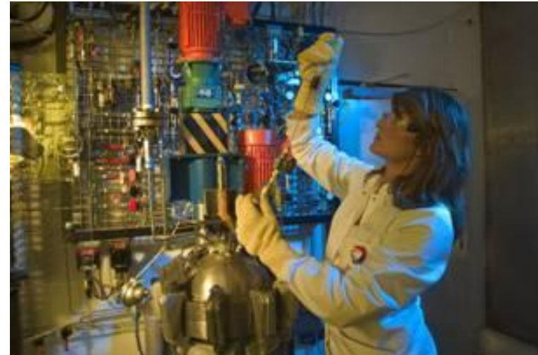
Réacteur de polymérisation haute pression (20-40 bar)
